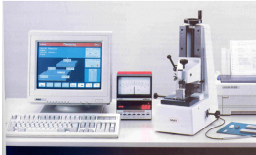
รูปที่ 6 เครื่องที่ใช้ในการสอบเทียบเกจบล็อกแบบเปรียบเทียบค่า
