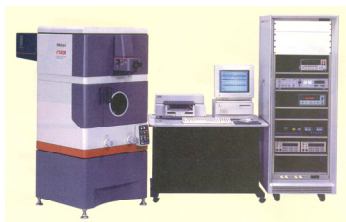
รูปที่ 7 เครื่องที่ใช้ในการสอบเทียบเกจบล็อกแบบวัดโดยตรง
