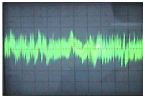
V/D = 50\text{mV} T/D = 1\text{ms} ภาพที่ 20 รูปสัญญาณที่วัดได้ที่จุด TP10
