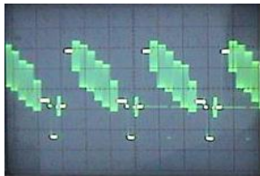
V/D = 0.1V T/D = 20\mu s รูปที่ 13 รูปสัญญาณที่วัดได้ที่จุด TP3
