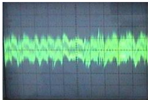
V/D = 50\text{mV} T/D = 20\mu\text{s} ภาพที่ 21 รูปสัญญาณที่วัดได้ที่จุด TP11
