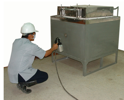
รูปที่ 8 การพ่นสีเตาไฟฟ้า
