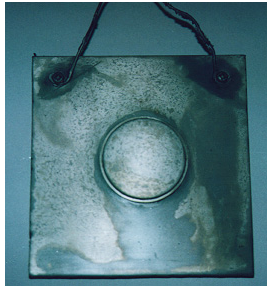
รูปที่ 6 ผิวที่ได้จากการชุบ Woods Nickel Strike
