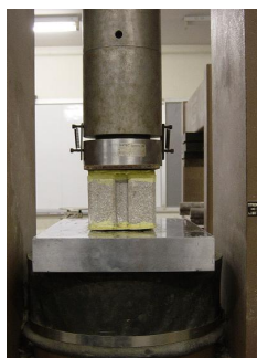
รูปที่ 4 การทดสอบกำลังอัดของคอนกรีตบล็อกประดับ
