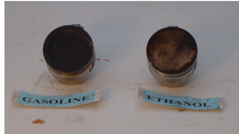
รูปที่ 5 ลูกสูบของเครื่องยนต์ เอทานอลและเครื่องยนต์แก๊สโซลีน หลังการทดสอบ
