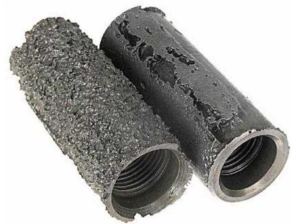
รูปที่ 7 การเสียหายจากการกัดกร่อนจากสภาพบรรยากาศ
