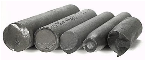
รูปที่ 1 ตัวอย่างรอยเสียหายจากแรงดึง และจากการล้า
