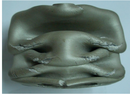
รูปที่ 3 การเสียหายจากความเค้นอัด
