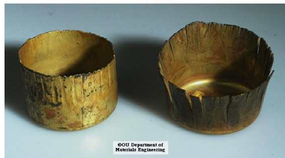
รูปที่ 6 การเสียหายแบบ Stress Corrosion Cracking
