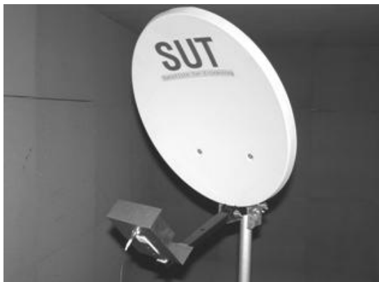
รูปที่ 10 สายอากาศแถบความถี่กว้างติดตั้งร่วมกับตัวสะท้อนคลื่นพาราโบลาแบบออฟเซต
