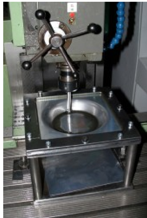
รูปที่ 3 เครื่องมือกลและอุปกรณ์ที่ใช้ในกระบวนการ SPIF
