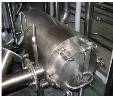
รูปที่ 7 ลักษณะและชิ้นส่วนภายในของเครื่องแลกเปลี่ยนความร้อนตัวอุ่นก่อน
