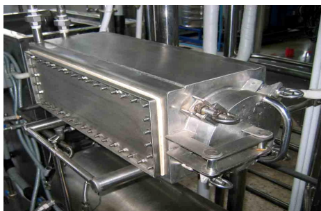
รูปที่ 7 ลักษณะและชิ้นส่วนภายในของเครื่องแลกเปลี่ยนความร้อนตัวอุ่นก่อน
