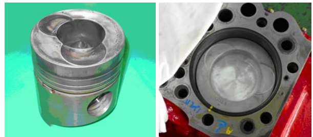
รูปที่ 8 ลูกสูบก่อนและหลังการลดอัตราส่วนการอัด
