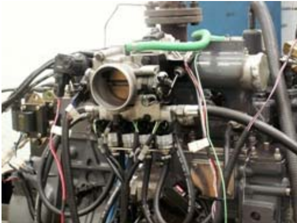
รูปที่ 1 ระบบหัวฉีดก๊าซธรรมชาติแบบแยกสูบ (MPI)
