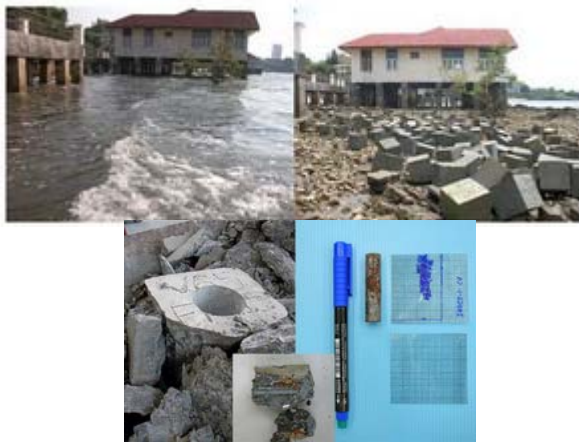
รูปที่ 1 การเตรียมตัวอย่างเพื่อทดสอบปริมาณคลอไรด์วิกฤติ
