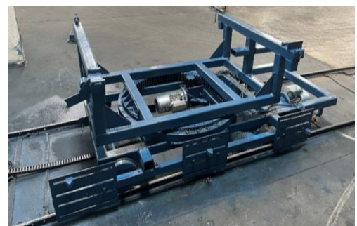
รูปที่ 8 อุปกรณ์จับยึด (Fixture) เครื่องทอตัวแบบเคลื่อนที่อัตโนมัติที่เสร็จแล้ว
