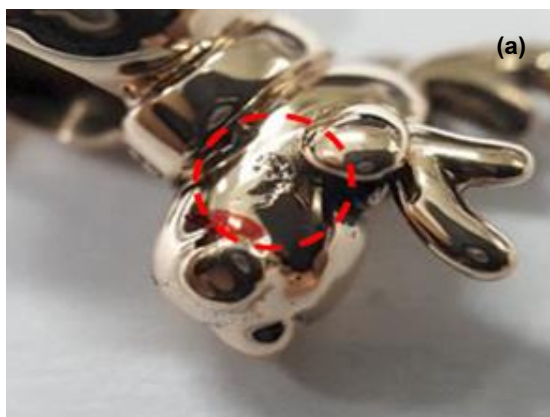
รูปที่ 1 ตัวอย่างชิ้นงานที่พบข้อบกพร่องแบบรูพรุน (a) รูพรุนบริเวณทางเข้าโพรงแบบของโลหะเหลว (b) ภาพขยายของรูพรุน
