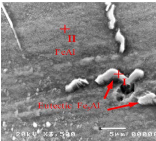
รูปที่ 7 โครงสร้างจุลภาคแนวเชื่อมพอกผิวแข็ง และสเปกตรัมของการวิเคราะห์ด้วย EDS ความเร็วในการเติมลวดอลูมิเนียม 5 เมตร/นาทึ
