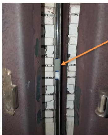
รูปที่ 3 ลักษณะการบรรจุตัวเร่งปฏิกิริยาในเครื่องปฏิกรณ์แบบเบดนิ่ง
