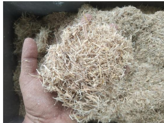
รูปที่ 4 ลักษณะเศษทางปาล์มน้ำมันที่บดย่อยแล้ว
