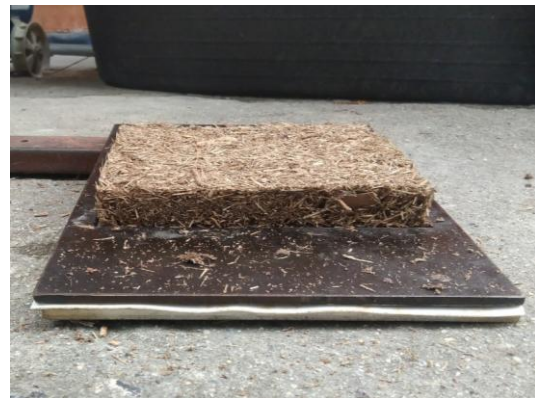
รูปที่ 5 ส่วนผสมที่เกลี่ยและอัดก่อนนำไปอัดขึ้นรูป
