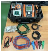
รูปที่ 4 Solar IV Full PV System Analyzer
