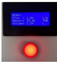
รูปที่ 15 ปริมาณน้ำที่สามารถใช้น้อยกว่า 5 ลิตร (ไฟแจ้งเตือนจะกะพริบ)
