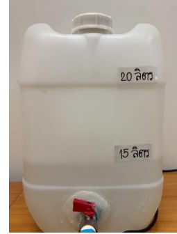
รูปที่ 26 หลังจากใช้น้ำไป 5 ลิตร ค่าปริมาณน้ำในถัง จาก 20 ลิตร ลดลงเป็น 15 ลิตร
