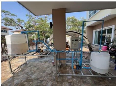
รูปที่ 7 แบบจำลองระบบผลิตไฟฟ้าพลังน้ำ
