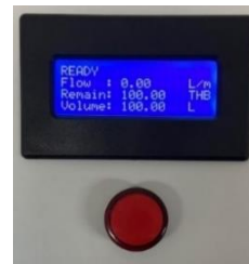
รูปที่ 21 ค่าปริมาณน้ำที่วัดได้จากเครื่องควบคุมที่สร้างขึ้น เริ่มต้น 100 ลิตร
