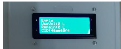
รูปที่ 28 ค่าปริมาณน้ำคงเหลือที่แสดงในระบบที่ สามารถใช้ได้มีค่าเท่ากับ 0 ลิตร
