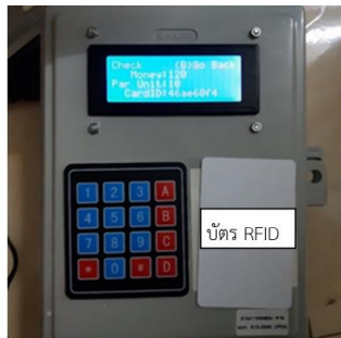
รูปที่ 25 เต็มเงินลงในบัตรเป็นจำนวน 120 บาท เพื่อให้ใช้น้ำได้ 12 ลิตร
