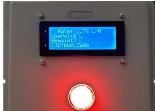
รูปที่ 15 ค่าปริมาณน้ำในระบบที่สามารถใช้ได้มีค่าน้อยกว่าห้าลิตร หลอด LED ติด
