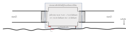
รูปที่ 3 ชุดทดสอบที่ 2 ท่อเหล็กกล่องไม่ติดตั้งครีบบระบายความร้อน (มุมมองด้านข้าง)
