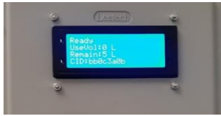
รูปที่ 14 ค่าปริมาณน้ำที่สามารถใช้ได้มีค่าเท่ากับหรือมากกว่าหนึ่งลิตร ระบบเปิดอัตโนมัติ
