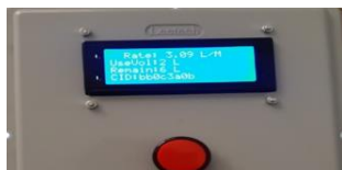
รูปที่ 17 ค่าปริมาณน้ำที่สามารถใช้ได้มีค่ามากกว่าหรือเท่ากับห้าลิตร หลอด LED ดับ
