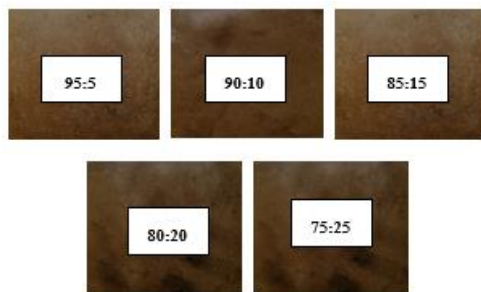
รูปที่ 7 แผ่นไม้เทียมอัตราส่วนต่างๆ ที่อัดขึ้นรูปแล้ว
