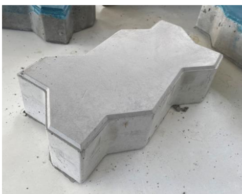
รูปที่ 6 บล็อกปูพื้นรูปคดกริช (อิฐตัวหนอน) ขนาด 11.5 x 22.5 x 6 เซนติเมตร
