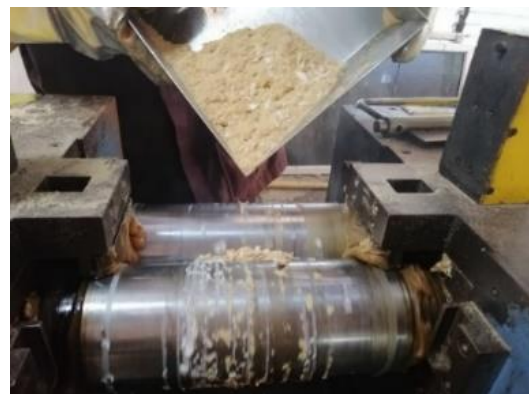
รูปที่ 5 การผสมเศษพลาสติกและผงไม้พาเลท
