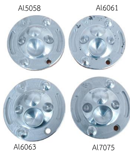
รูปที่ 2 อะลูมิเนียมทั้ง 4 เกรดหลังผ่านกระบวนการตัดเฉือน
