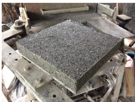
รูปที่ 5 บล็อกปูพื้นขนาด 30 x 30 x 5 เซนติเมตร
