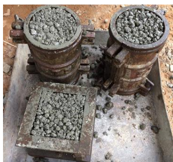
รูปที่ 5 เทคอนกรีตพูนลงในแบบหล่อคอนกรีต
