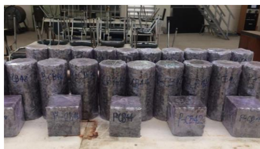
รูปที่ 6 คอนกรีตพูนที่ห่อด้วยฟิล์ม
