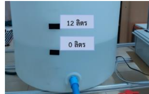
รูปที่ 27 หลังจากใช้น้ำไป 12 ลิตร ค่าปริมาณน้ำในถัง ลดลงเป็น 0 ลิตร
