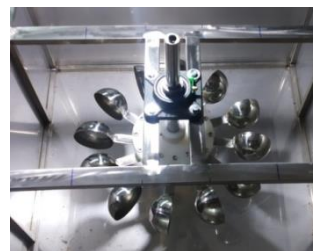
รูปที่ 1 ใบพัดของกังหันน้ำแบบเพลตันที่สร้างขึ้นเองอย่างง่าย
