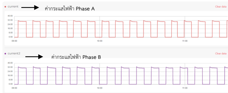
รูปที่ 17 การแสดงผลค่ากระแสไฟฟ้า (Current) ย้อนหลังผ่าน NETPIE Feed
