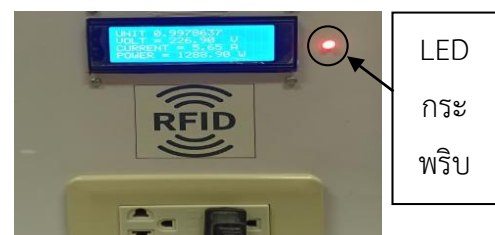
รูปที่ 16 ค่าพลังงานไฟฟ้าในระบบที่สามารถใช้ได้มีค่าน้อยกว่าหนึ่งหน่วย หลอด LED กระพริบ
