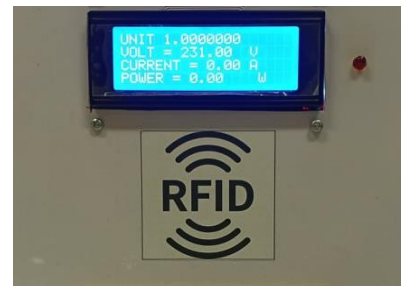
รูปที่ 15 ค่าพลังงานไฟฟ้าที่ใช้ได้มีค่าเท่ากับ หนึ่งหน่วย ระบบเปิดอัตโนมัติ
