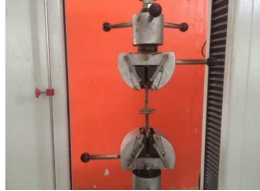
รูปที่ 7 การทดสอบความต้านทานแรงดึงตั้งฉากกับผิวหน้าของแผ่นขึ้นไม้อัด
