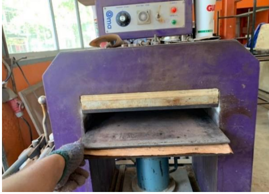
รูปที่ 4 การนำเปลือกไม้กระถินณรงค์ที่ผ่านการเรียงตัวแล้ว ไปใส่ในเครื่องอัดขึ้นรูปด้วยความร้อน
