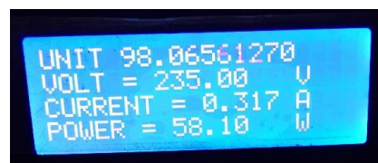
รูปที่ 23 ค่าพลังงานไฟฟ้าที่เหลืออยู่และสามารถใช้งานได้ ที่อ่านได้จากระบบควบคุมที่นำเสนอ เมื่อครบกำหนด 3 วัน คงเหลือ 98.06561270 หน่วย
