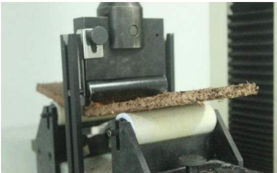
รูปที่ 6 การทดสอบความต้านทานแรงดัดของแผ่นขึ้นไม้อัด
