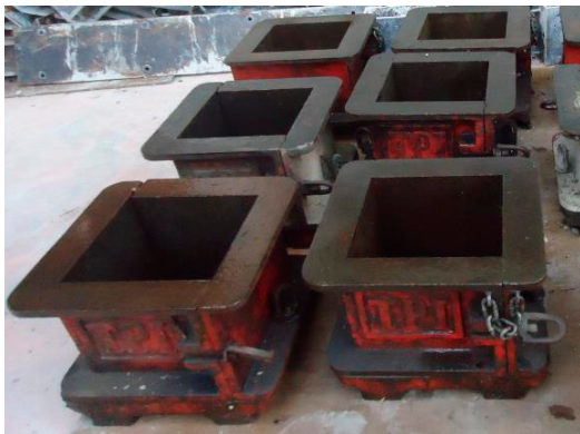
รูปที่ 2 แบบหล่อคอนกรีต ขนาด 15 x 15 x 15 เซนติเมตร
