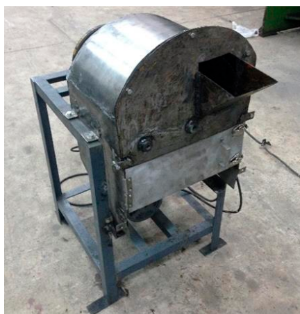
ข) เครื่องแยกเส้นใยลูกตาลสดต้นแบบรูปที่ 3 แบบและเครื่องแยกเส้นใยลูกตาลสดต้นแบบ
