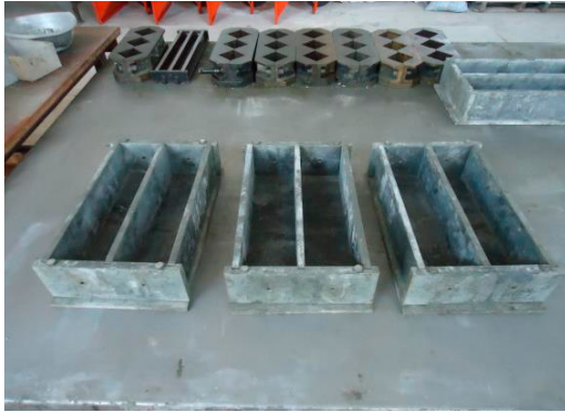
รูปที่ 1 แบบหล่อคอนกรีต ขนาด 7.50 x 7.50 x 28.50 เซนติเมตร
