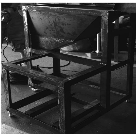
รูปที่ 6 โครงสร้างเครื่องย่อยทางปาล์มทำจาก เหล็กกล้าคาร์บอน SS400
