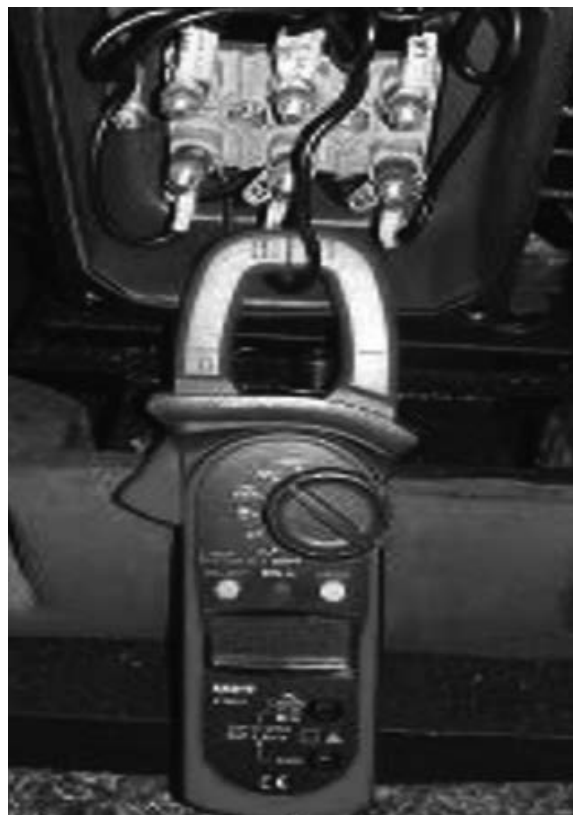
รูปที่ 3 การวัดปริมาณกระแสไฟฟ้าด้วยแอมป์มิเตอร์
