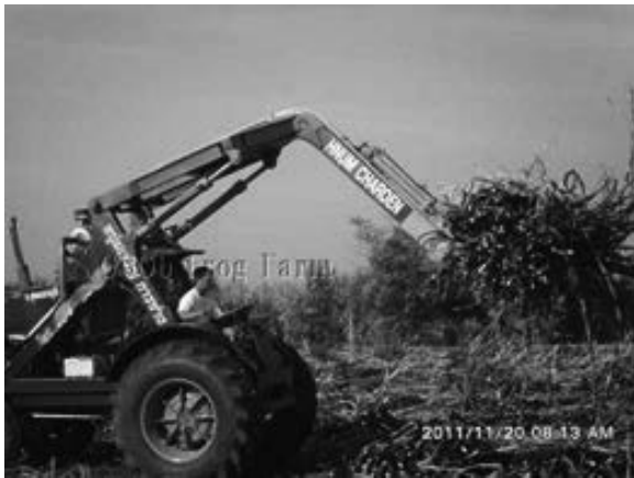
รูปที่ 10 การทดสอบการทำงานของรถคืบอ้อย แบบคืบหลัง
