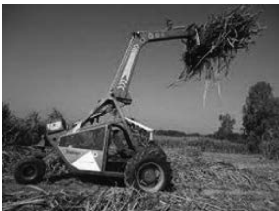
รูปที่ 11 การทดสอบการทำงานของรถคืบอ้อย แบบสามล้อ
