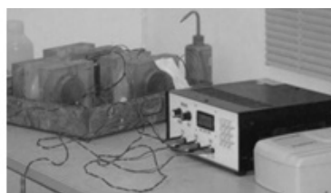
รูปที่ 4 การประกอบเซลล์เข้ากับชุดทดสอบแบบเร่งให้เกิดการแทรกซึมของคลอไรด์ไอออน
