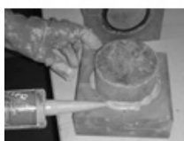
รูปที่ 4 การประกอบเซลล์เข้ากับชุดทดสอบแบบเร่งให้เกิดการแทรกซึมของคลอไรด์ไอออน
