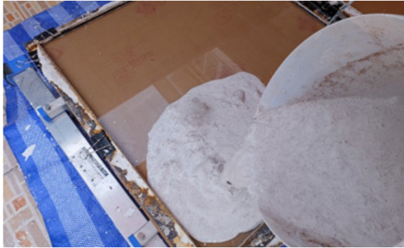
รูปที่ 3 การเทส่วนผสมผ้าเพดานลงในแบบหล่อ
