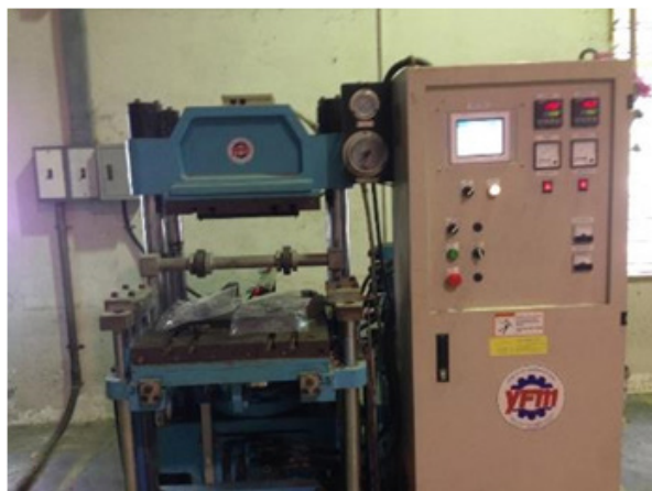
รูปที่ 6 การขึ้นรูปด้วยเครื่องอัดความร้อน
