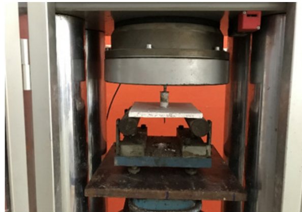
รูปที่ 5 การทดสอบแรงต้านทานการดัดงอของแผ่นผ้าเพดานขุยมะพร้าว
