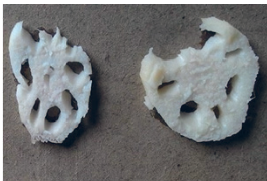
รูปที่ 10 ชิ้นเหง้าบัวที่เสียหลังการสไลด์ด้วยเครื่อง
