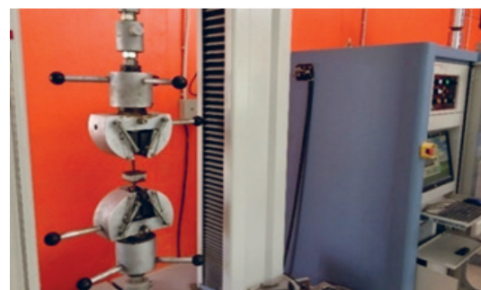
รูปที่ 3 การทดสอบความต้านทานแรงดึงตั้งฉากที่ผิวหน้า
