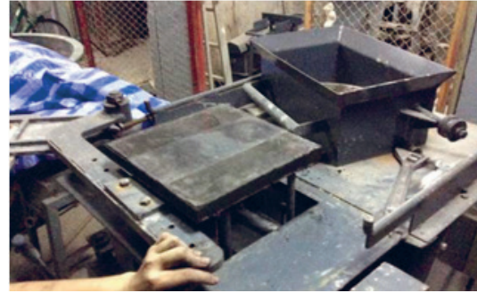
รูปที่ 2 การขึ้นรูปด้วยเครื่องอัดแผ่นซีเมนต์บอร์ด
