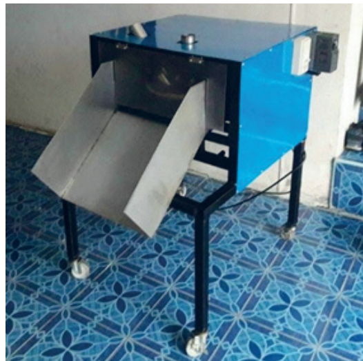
รูปที่ 6 ลักษณะเครื่องสไลด์เห้างบัว
