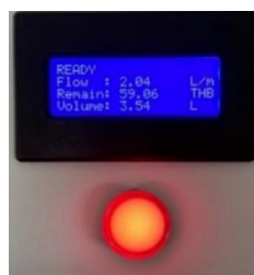
รูปที่ 15 ปริมาณน้ำที่สามารถใช้ได้น้อยกว่า 5 ลิตร (ไฟแจ้งเตือนจะกระพริบ)
