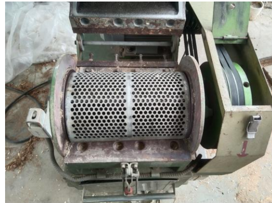
รูปที่ 2 เครื่องบดย่อยพลาสติก พร้อมตะแกรง
