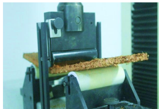
รูปที่ 6 การรับแรงดัดของตัวอย่างแผ่นขึ้นไม้อัด
