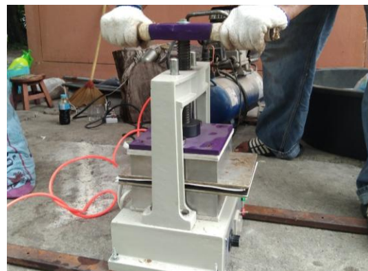
รูปที่ 3 เครื่องอัดขึ้นรูปด้วยความร้อนแบบมือหมุนชนิดอัตรา
