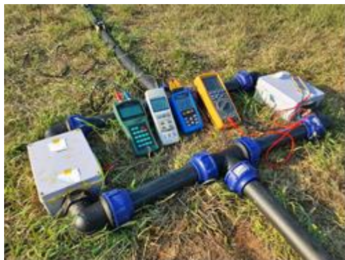
รูปที่ 5 เครื่องมือ และชุดทดสอบการใช้น้ำร้อนจากท่อส่งน้ำที่สัมผัสกับแสงอาทิตย์เพื่อผลิตไฟฟ้าจากเทอร์โมอิเล็กทริก
