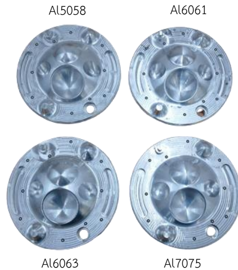
รูปที่ 3 การสร้างจุดอ้างอิงที่มีตำแหน่งเดียวกันและจำนวนเท่ากันก่อนทำการ (Scanning)
