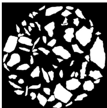
รูปที่ 6 ภาพตัวอย่างขาวดำที่ผ่านการคัดเลือกขอบเขตของมวลรวมหยาบ
