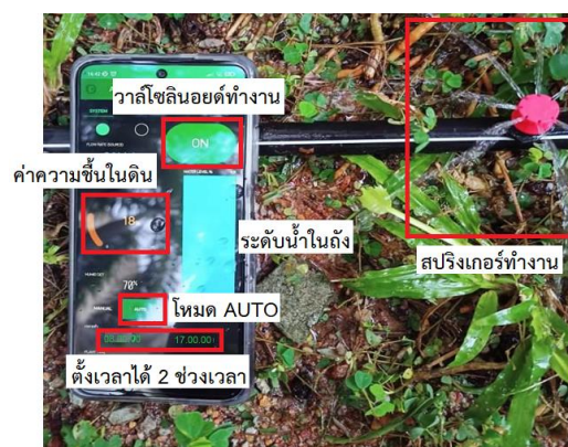
รูปที่ 15 วาล์วโซลินอยด์ทำงานอัตโนมัติ
