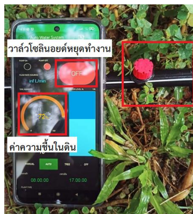
รูปที่ 16 วาล์วโซลินอยด์หยุดทำงานอัตโนมัติ
