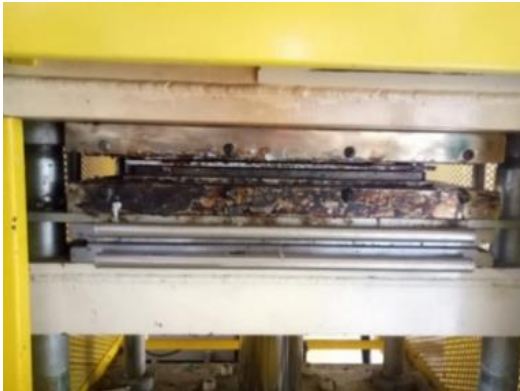
รูปที่ 6 การอัดแผ่นไม้เทียม
