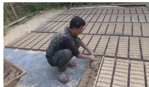
รูปที่ 7 การผลิตวัสดุก่อสร้างจากซีเมนต์, น้ำสะอาด และกระดาษเหลือทิ้ง
