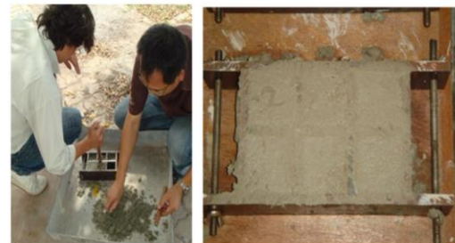
รูปที่ 6 ตรวจสอบคุณสมบัติเบื้องต้นจากการขึ้นรูปส่วนผสมซีเมนต์, น้ำ และกระดาษเหลือทิ้ง
