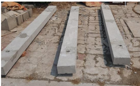
รูปที่ 12 ต้นแบบคั่นกันล้อรถยนต์จากเศษขุยมะพร้าวพลาสติก (วัสดุเหลือทิ้งจากการผลิตพลาสติกรีไซเคิล)
