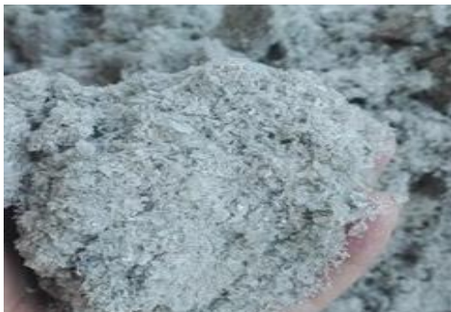
รูปที่ 6 ขุยพลาสติกที่วัสดุเหลือทิ้งจากการผลิตพลาสติกรีไซเคิล
