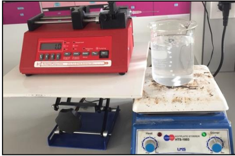
รูปที่ 2 การขึ้นรูปปิดโคโตซาน
