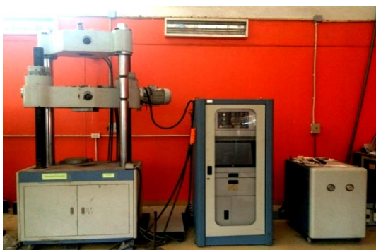
รูปที่ 4 เครื่องทดสอบแรงกดอัด
