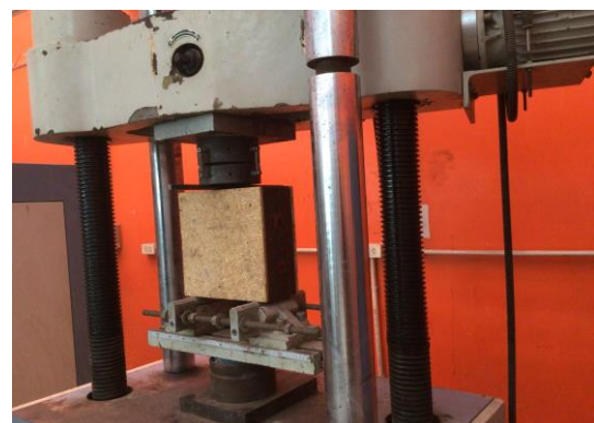
รูปที่ 11 การทดสอบความต้านทานแรงดัด
