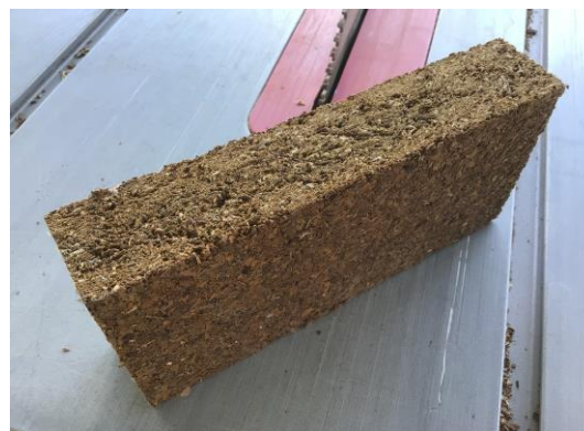
รูปที่ 8 ชิ้นงานแกนฉนวนไส้กลางจากเศษใยยางพารา
