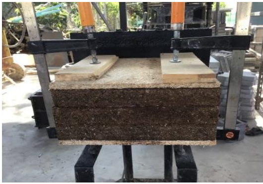
รูปที่ 9 การประกอบชิ้นงานส่วนของผนังแผ่นขึ้นไม้อัด และส่วนของแกนไส้กลางด้วยกาวติดไม้
