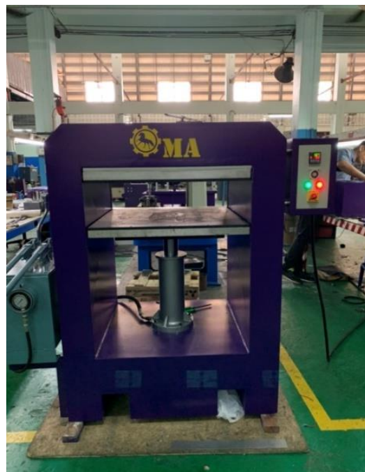
รูปที่ 2 เครื่องอัดร้อนใช้ไฮดรอลิกแบบมือโยกขนาดแผ่นเพลท 40 x 40 ซม.
