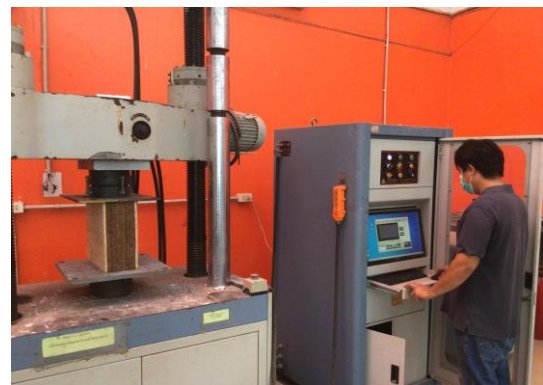
รูปที่ 10 การทดสอบความต้านทานแรงอัด
