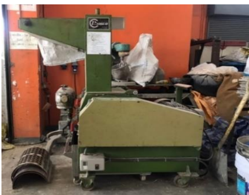
รูปที่ 5 เครื่องบดย่อยวัสดุพร้อมตะแกรงขนาด 6 มม.
