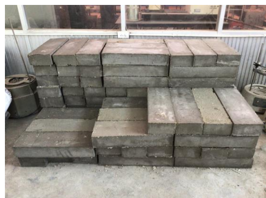
รูปที่ 15 เฮมพ์กรีตขนาด 10 x 20 x 60 ซม.
