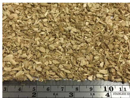
รูปที่ 1 แกนกัญชงที่บดย่อยผ่านตะแกรงขนาด 6 มม.
