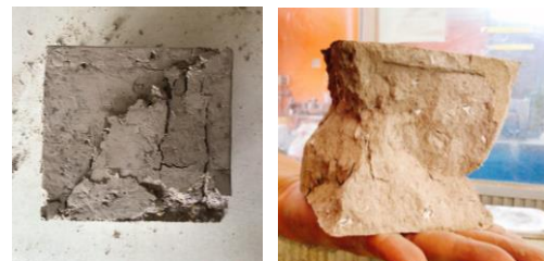
รูปที่ 11 ลักษณะการแตกหักของก้อนตัวอย่าง
