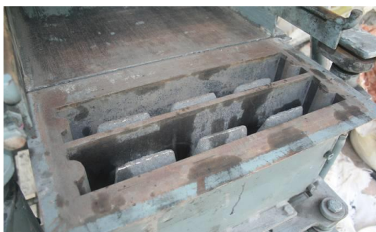
รูปที่ 2 แบบหล่อคอนกรีตบล็อกกลวง
