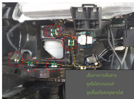
รูปที่ 1 ตัวอย่างการออกแบบเส้นทางการเดินชุดสายไฟผ่านตามจุดที่กำหนด
