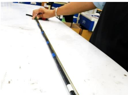
รูปที่ 5 ลักษณะของการวัดความยาวของชุดสายไฟรถยนต์
