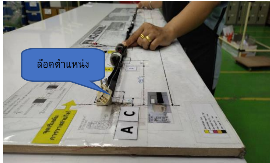
รูปที่ 8 ลักษณะของการวัดความยาวของชุดสายไฟรถยนต์ด้วยใช้บอร์ดวัดชิ้นงาน
