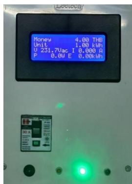
รูปที่ 11 ค่าพลังงานไฟฟ้าที่ใช้ได้มีค่าเท่ากับหนึ่งหน่วย ระบบเปิดอัตโนมัติ
