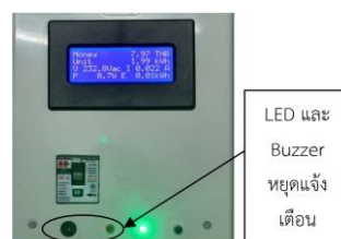
รูปที่ 14 ค่าพลังงานไฟฟ้าที่ใช้ได้มีค่ามากกว่าหนึ่งหน่วยหลอด LED และ Buzzer หยุดการแจ้งเตือน
