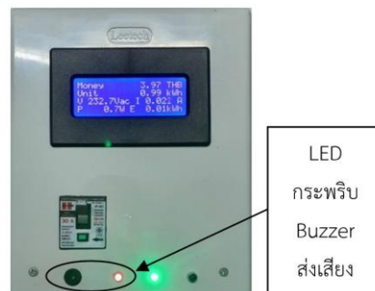
รูปที่ 12 ค่าพลังงานไฟฟ้าในระบบที่สามารถใช้ได้มีค่าน้อยกว่าหนึ่งหน่วย หลอด LED กระพริบ
