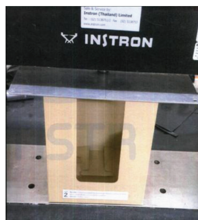
รูปที่ 10 การทดสอบความต้านแรงกด บรรจุภัณฑ์ รูปแบบที่ 2
