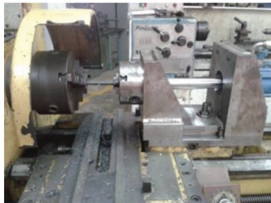
รูปที่ 10 การจับยึดชิ้นงานกับเครื่องกลึง
