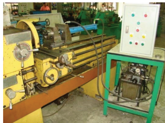
รูปที่ 3 เครื่องเชื่อมด้วยแรงเสียดทาน
