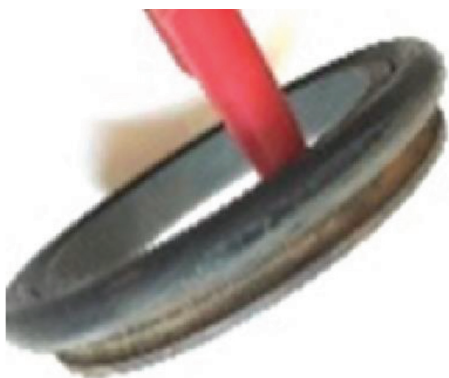
รูปที่ 3 ปัญหา F19 การสึกหรอของลูกยางโอริง
