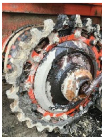
รูปที่ 5 ปัญหา F10 เฟืองสเตอร์สปีกเกิดชำรุด
