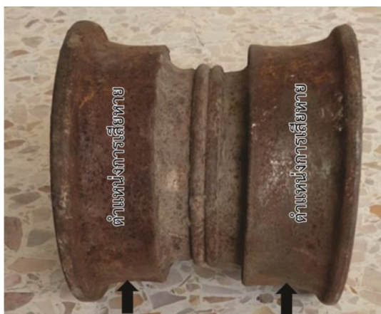
รูปที่ 4 ปัญหา F14 การสึกหรอบนพื้นผิวของลูกโรลเลอร์
