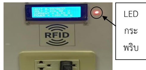
รูปที่ 16 ค่าพลังงานไฟฟ้าในระบบที่สามารถใช้ได้มีค่าน้อยกว่าหนึ่งหน่วย หลอด LED กระพริบ
