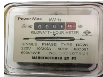
รูปที่ 20 ค่าพลังงานไฟฟ้าจากกิโลวัตต์-ชั่วโมง มิเตอร์ เริ่มต้นที่ 8.52 หน่วย
