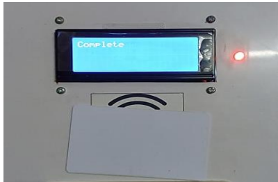
รูปที่ 17 การเติมเงินเข้าระบบขณะมีโหลดต่อใช้งาน
