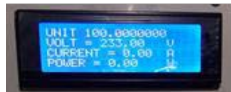
รูปที่ 21 ค่าพลังงานไฟฟ้าที่สามารถใช้ได้จากระบบควบคุม ที่นำเสนอมีค่าเริ่มต้นที่ 100 หน่วย
