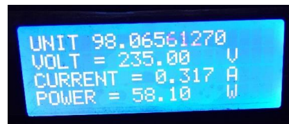
รูปที่ 23 ค่าพลังงานไฟฟ้าที่เหลืออยู่และสามารถใช้ได้ทีที่อ่านได้จากระบบควบคุมที่นำเสนอ เมื่อครบกำหนด 3 วัน คงเหลือ 98.06561270 หน่วย
