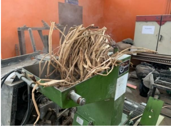
รูปที่ 1 การย่อยและตัดขนาดเส้นใยจากก้านผักตบชวา
