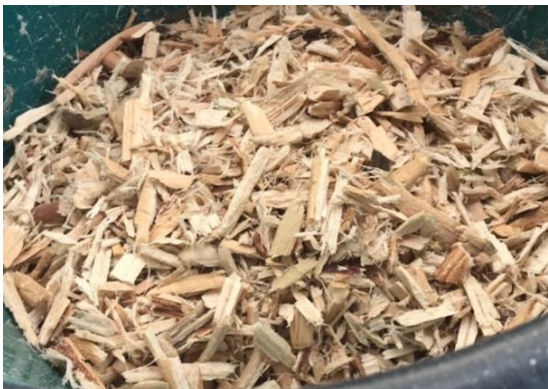
รูปที่ 2 เส้นใยจากก้านผักตบชวาที่ผ่านการบดย่อยแล้ว
