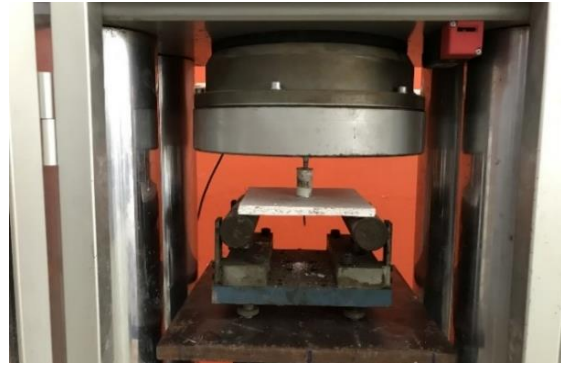
รูปที่ 7 การทดสอบแรงต้านการดึงตะปูของแผ่นยิปซัม
