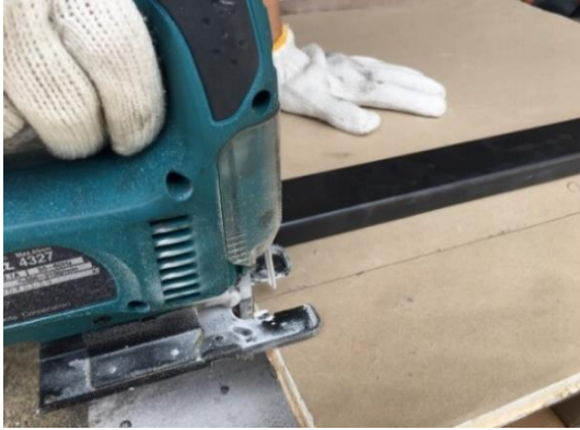
รูปที่ 18 การทดสอบตัดแผ่นยิปซัมด้วยเลื่อยไฟฟ้า
