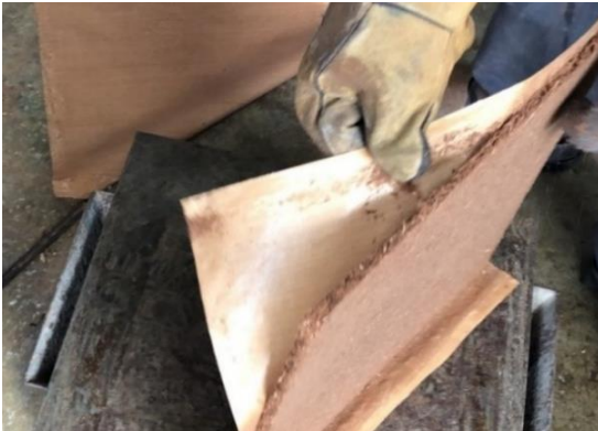
รูปที่ 5 นำแผ่นเทพล่อนออกจากแผ่นขึ้นไม้อัดที่ขึ้นรูป
