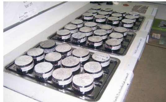
รูปที่ 2 การทดสอบการดูดซึมน้ำของมอร์ตาร์
