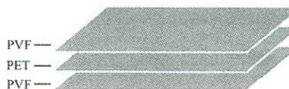
รูปที่ 7 แผ่นปิดด้านหลังโครงสร้างเป็นพีวีเอฟและพีโอที
