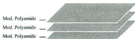
รูปที่ 8 แผ่นปิดด้านหลังโครงสร้างเป็นโมดิไฟด์พอลิเอไมด์
