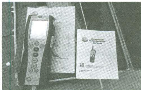
รูปที่ 5 เครื่องวัดประสิทธิภาพการเผาไหม้ รุ่น Testo 340
